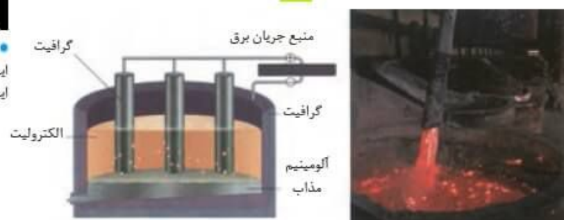
شکل ۱۸- فرایند هال برای تولید آلومینیم از Al_2O_3
