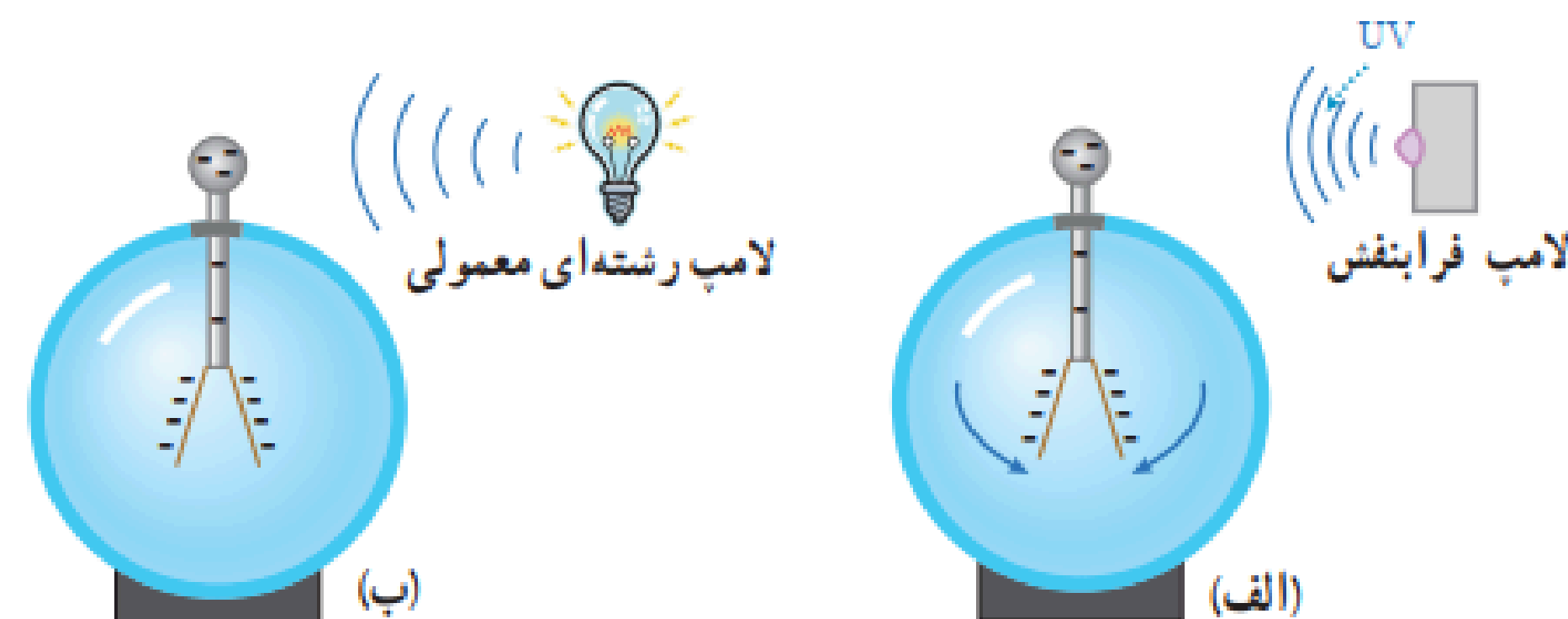
شکل ۱-۴ الف) برهم‌کنش نور فرودی فرابنفش با کلاهک برق‌نما سبب می‌شود تا ورقه‌های آن به سرعت به هم نزدیک شوند. ب) در حالی که برهم‌کنش نور مرئی گسیل شده از یک لامپ رشته‌ای تغییری در انحراف ورقه‌های برق‌نما به وجود نمی‌آورد.
