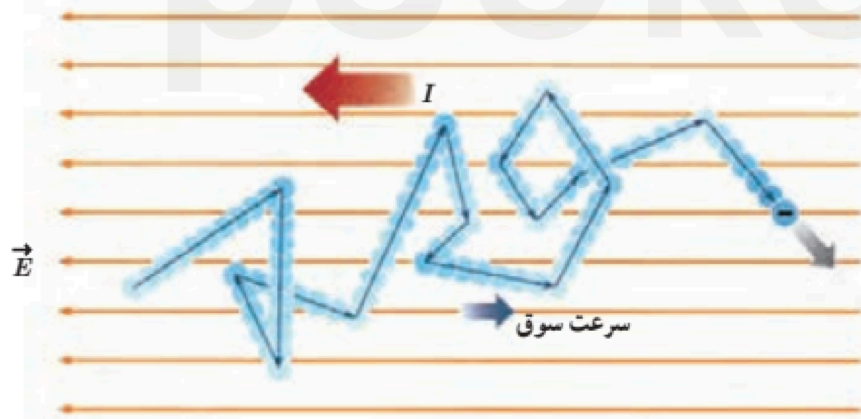
شکل ۷-۲ مسیر زیگزاگ یک الکترون آزاد در یک رسانای فلزی. در حضور میدان الکتریکی، این مسیر زیگزاگ در خلاف جهت میدان سوق یافته است. ۱
