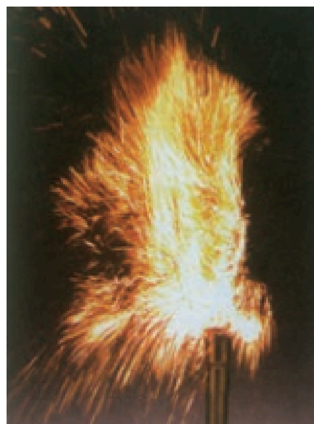
شکل ۹- سوختن گرد آهن. اغلب فلزها مانند آهن در شرایط مناسب با گاز اکسیژن می‌سوزند.
